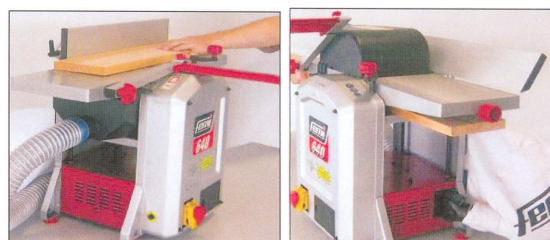
Piallatura a spessore (max mm 204 x H 210)
